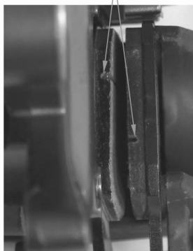
后制动摩擦片磨损极限位置
